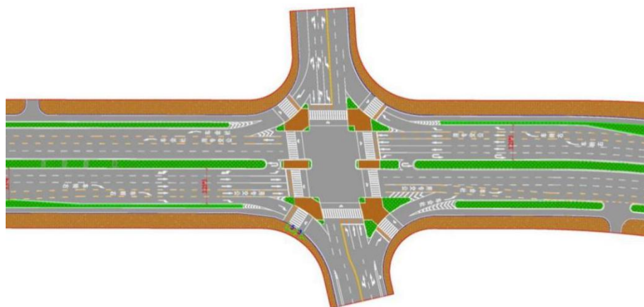
图 3.3-3 削除绿化带展宽进口道
